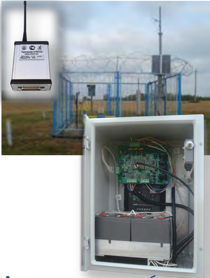
Аппаратура контроля объектов газоснабжения по радиоканалу с автономным питанием
