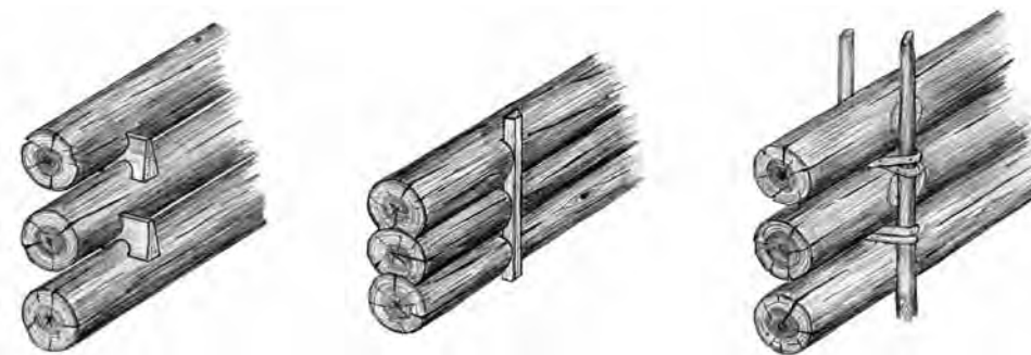
Рис. 28. Укрепление стены по высоте
