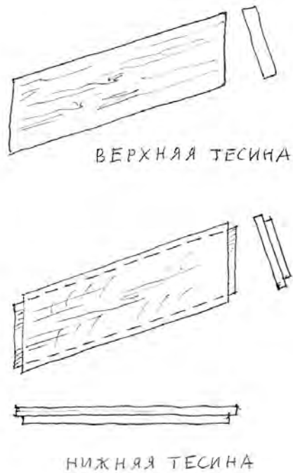
Рис. 13. Заполнение между балок потолка в церкви Успения из с. Курицко
