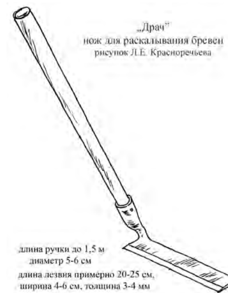
Рис. 7. Приспособление для расколки бревен
